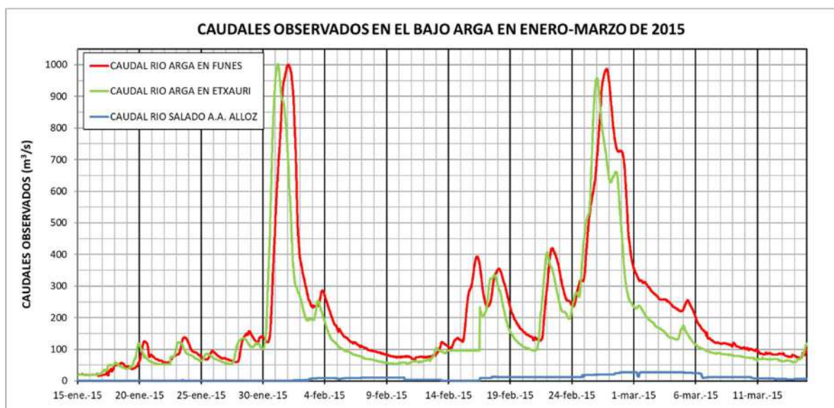
Figura 15 Caudales observados en tiempo real en las estaciones de aforo del Arga en Etxauri y en la estación de Funes durante las dos riadas ocurridas entre enero y marzo de 2015. Estas curvas permiten conocer el tiempo que tardó en circular el pico de la avenida entre ambas estaciones de medición de caudales.
